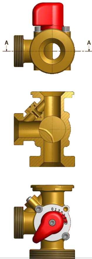
zawór mieszający częściowo otwarty, mieszanie proporcjonalne
